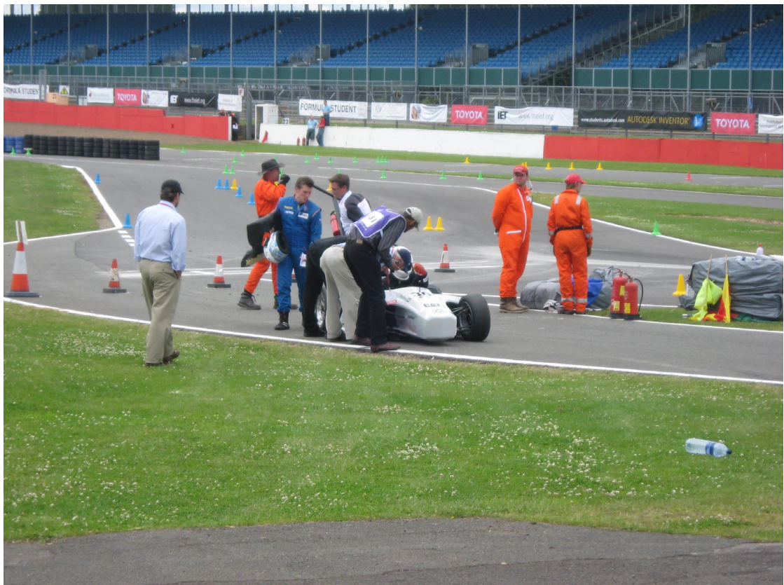
Bolid ETH Zuerich imao je sreću, ovjes prednjeg točka je otkazao na samom prijelazu ciljne crte
