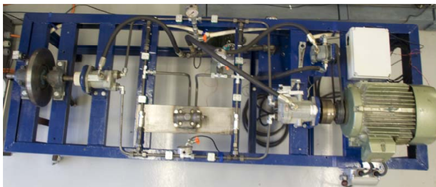
Slika 2.18. Laboratorijski sustav hidrostatske transmisije prema Lauvi i Lundu [41]
