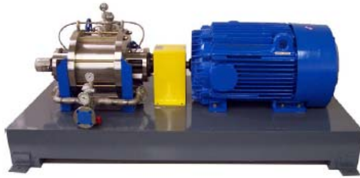
Slika 3.15. Komercijalni SPR reaktor za proizvodnju biodizela kojeg je razvila firma Hydro Dynamics [124].
