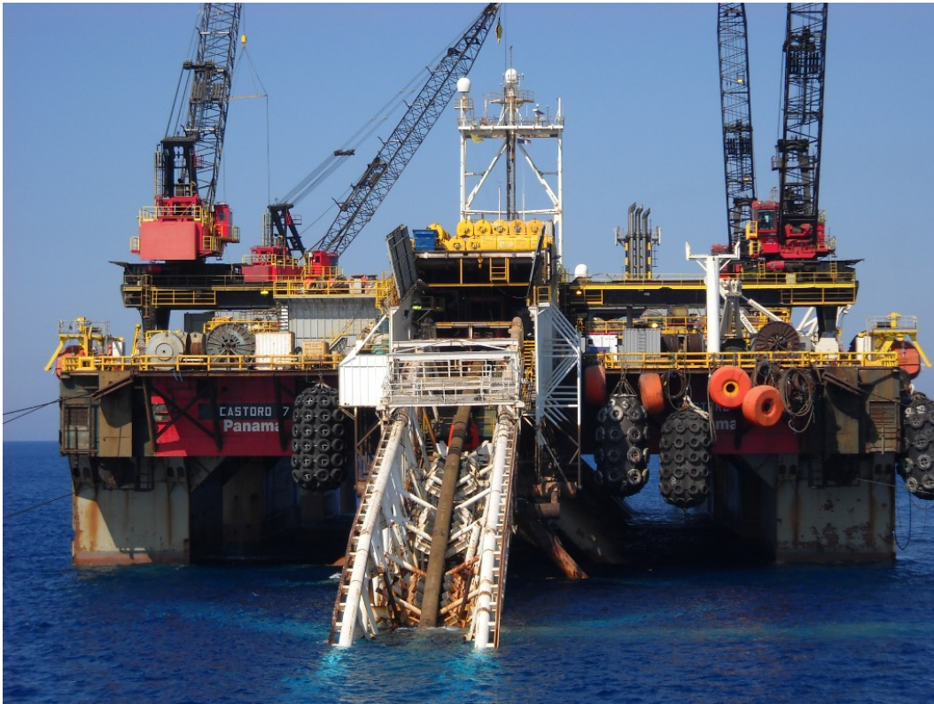
Slika 1.3: Polaganje podmorskih cjevovoda S-Lay metodom
