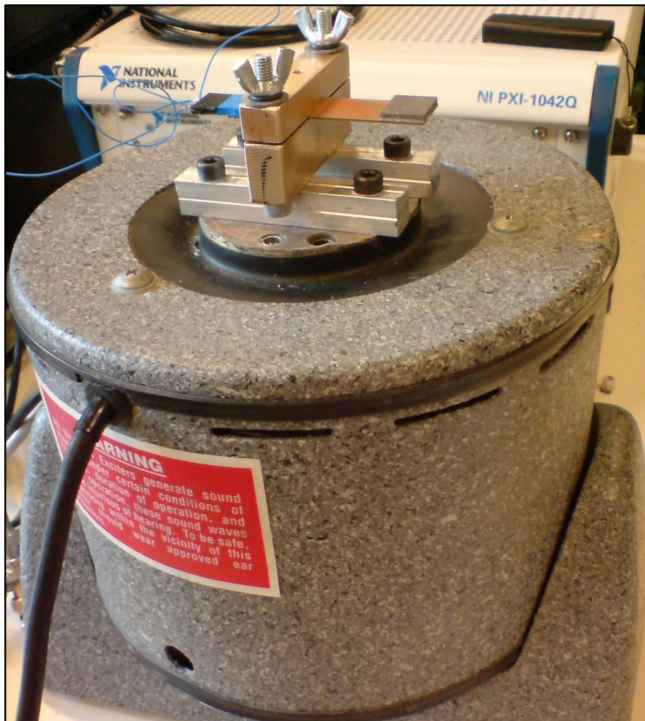
Slika 90. Uklještena piezoelektrična konzola s vršnom masom postavljena na elektromagnetski vibracijski uzбудnik MB Dynamics PM25A
