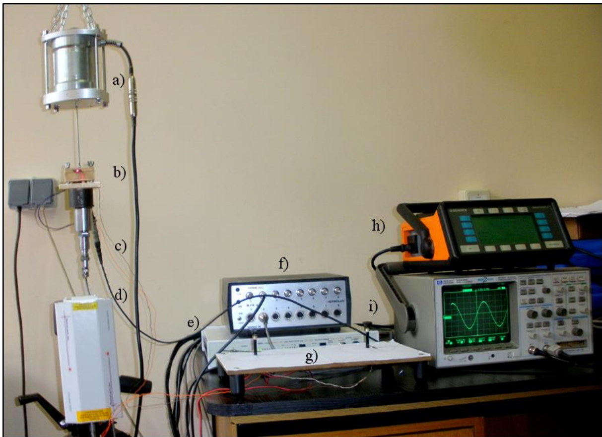
Slika 94. Eksperimentalni postav u Laboratoriju za precizno inženjerstvo: a) vibracijski uzбудnik Schenk AG Vibroexciter 41, b) uklještenje s konzolom, c) akcelerometar Schenk AS-020, d) laserski vibrometar MetroLaser VibroMet 500V, e) upravljačka jedinica vibrometra, f) upravljačka jedinica akcelerometra, g) potenciometri, h) upravljačka jedinica vibracijskog uzбудnika, i) osciloskop
