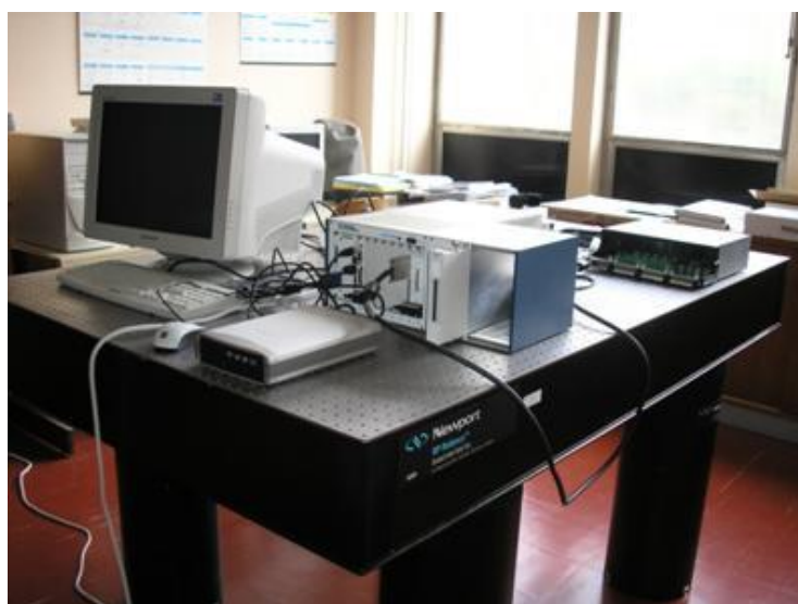
Slika 83. Laboratorij za precizno inženjerstvo pri Tehničkom fakultetu u Rijeci. Na slici je prikazan optički stol Newport i sustav za akviziciju podataka NI PXI
