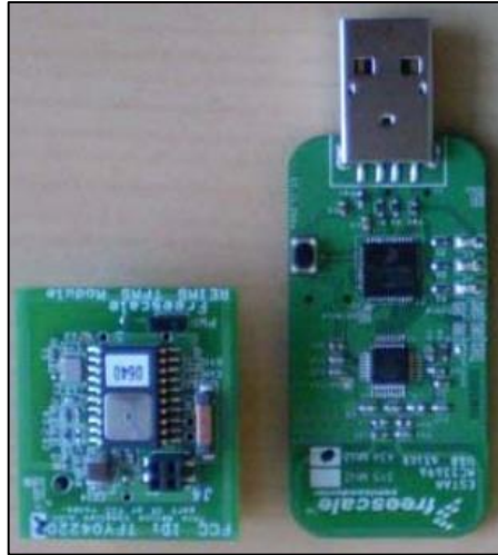
Slika 124. Freescale MPXY8300 mjerni modul s bežičnim primopredajnikom (lijevo) i USB sučelje s primopredajnikom (desno) [Petković, 2011.]
