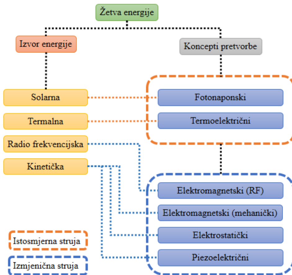
Slika 1. Prikaz najčešćih izvora energije i konceptata pretvorbe korištenih pri pretvorbi niskorazinske energije iz okoliša. Slika prilagođena prema: [Caliò et al., 2014.]
