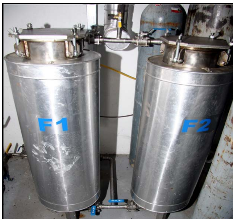
Slika 3.17. Završna filtracija biodizela
