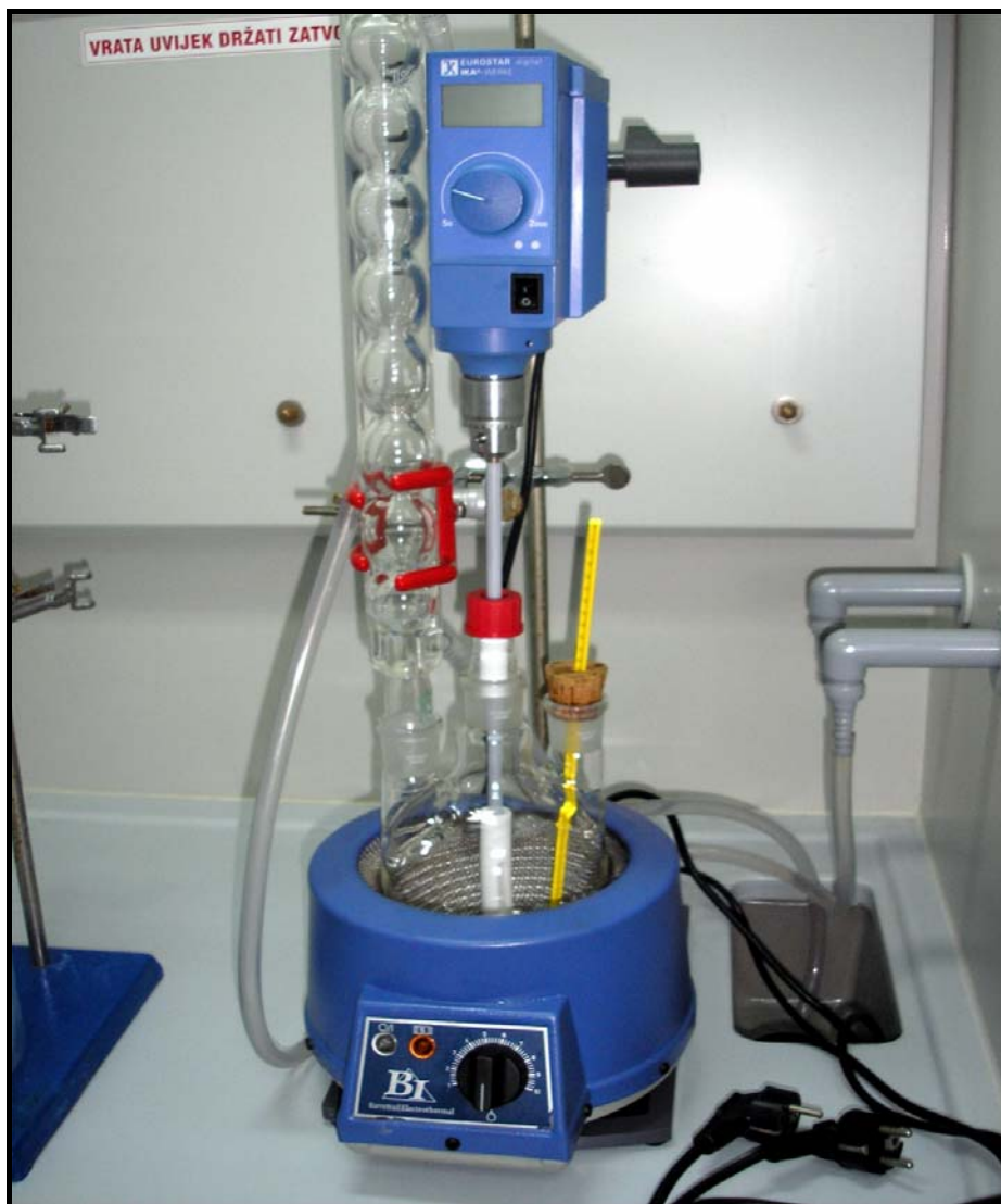
Slika 4.12. Reaktor za transesterifikaciju
