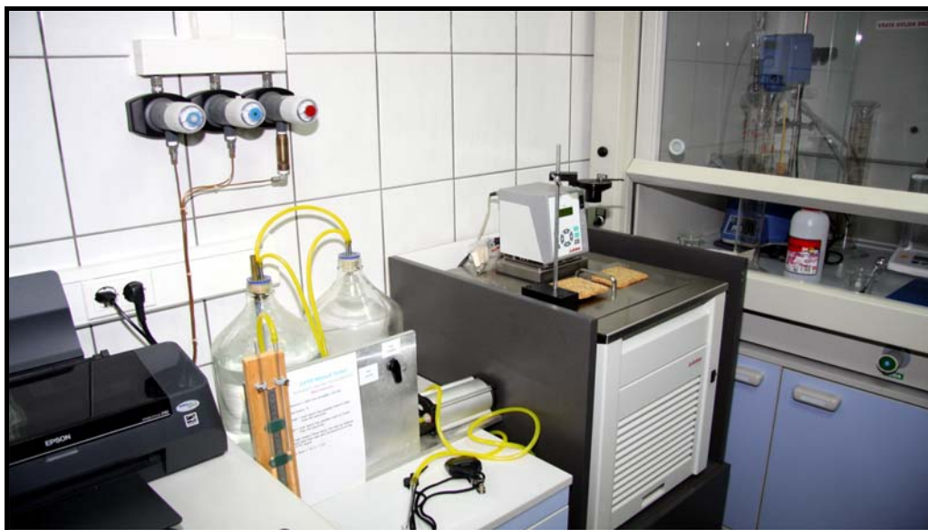
Slika 4.18. Uređaj za testiranje hladnih svojstava
