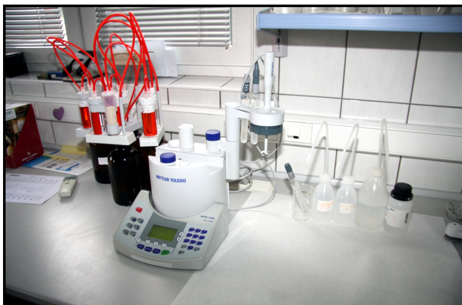
Slika 4.9. Automatski potenciometrijski titrator Mettler Toledo
