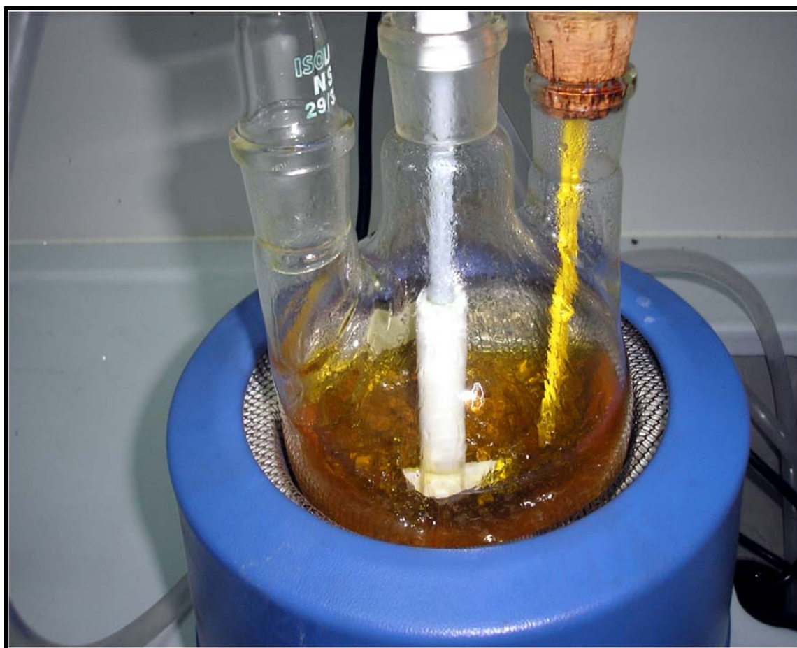
Slika 4.11. Reaktor za proizvodnju biodizela
