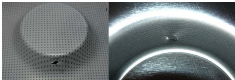
Slika 10.17 Pukotina nastala zbog nepravilnosti u strukturi materijala
