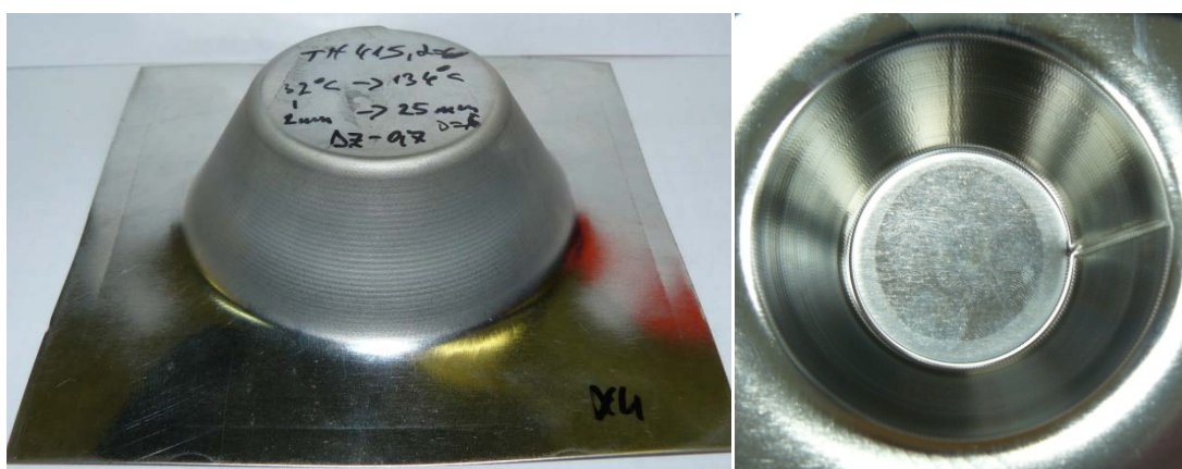
Slika 8.12 Prikaz izratka - lim TH415 X4 kut od 60^\circ
