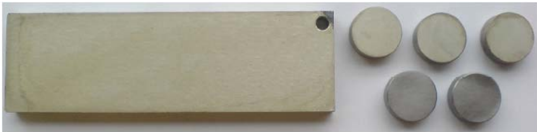
Slika 10.4 Epruvete za testiranje trenja, podložna ploča i alatna epruveta
