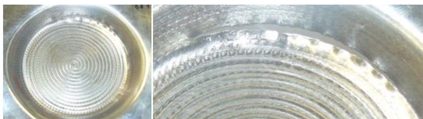
Slika 10.15 Popuštanje materijala pri hladnoj obradi na 15 mm visine, spiralna putanja, metoda deformiranja cjelokupne ravnine prije spuštanja na novu ravninu
