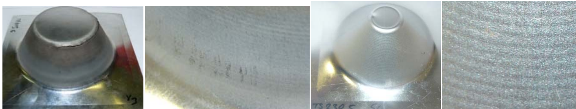
Slika 10.19 Ispitani uzorci X3 TH415 i X5 TS230 i prikaz površine
