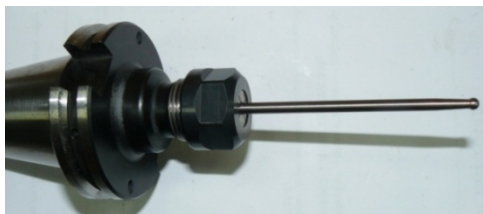
Slika 8.7 Standardni nosač alata CAT 40, stegnut alat promjera \text{Ø}6 mm
