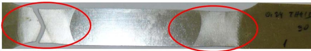
Slika 4.8 Pojava Lüdersovih traka pri izvedbi vlačnog testa, lim TH415
