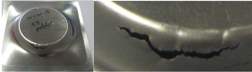
Slika 10.16 Popuštanje materijala kut 59° pri optimalnim parametrima 10 mm visine
