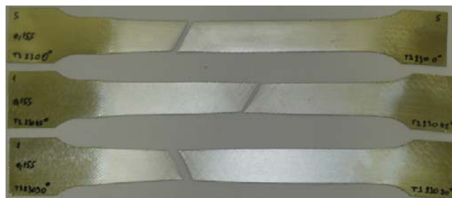
Slika 5.3 Vlačni test, ispitane epruvete, kut 0°, 45° i 90° - materijal TS230
