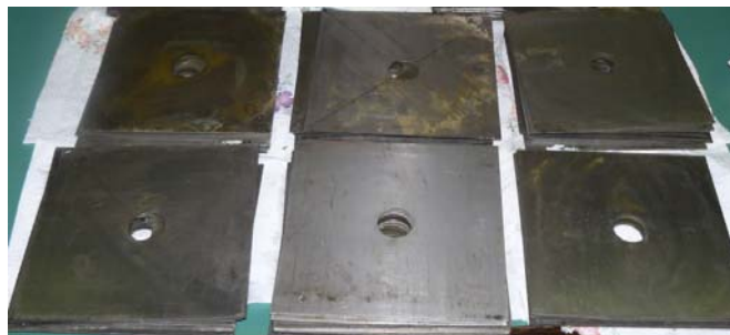
Slika 5.18 Pripremljene podložne ploče, materijal DC01 debljine 1 mm
