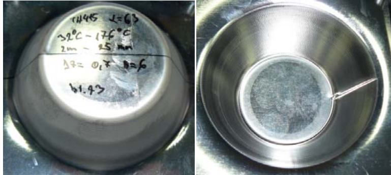
Slika 8.13 Prikaz izratka kut 63^\circ , lim TH415
