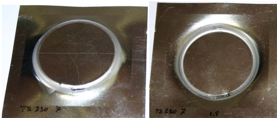
Slika 8.16 Uzorak TS230 - 7, kut 60° visina 7 mm
