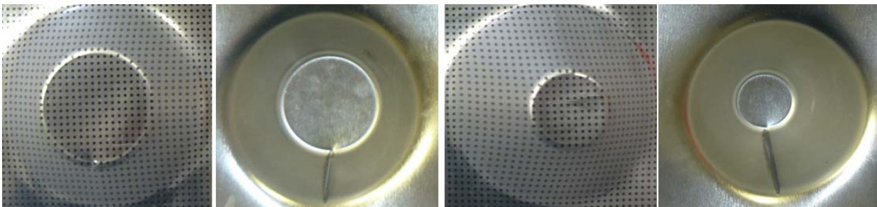
Slika 8.24 Prikaz 2 ispitivana stadija obrade, materijal THS230, 25 mm i 35 mm, kut 58°, alat Ø6 mm, \Delta z = 0,6 mm
