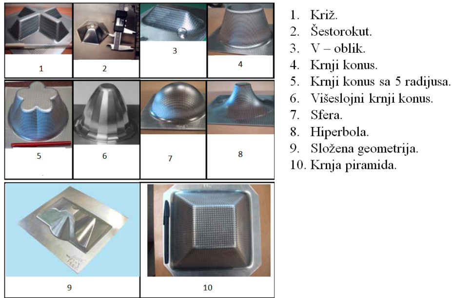
Slika 2.16 Vrste ispitnih uzoraka upotrebljavanih za izradu dijagrama sposobnosti oblikovanja u SPIF procesu [6]
