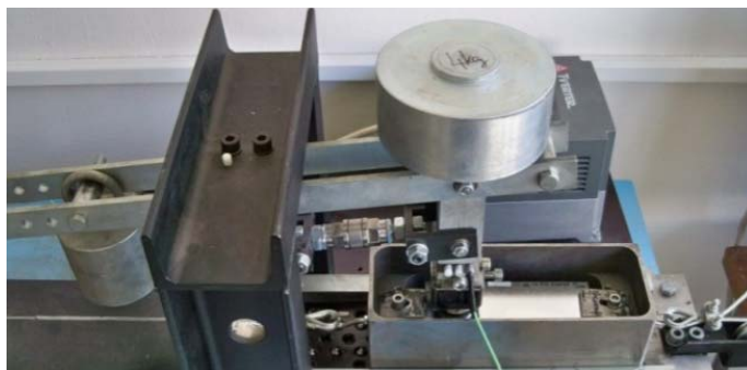
Slika 10.3 Uzorci opterećeni silom od 10 - 40 N u Tribometru TOP 3
