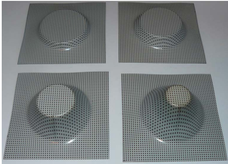
Slika 8.22 Prikaz 4 ispitivana stadija obrade za materijal TH415, 10 mm, 15 mm, 25 mm i 35 mm kut 63°
