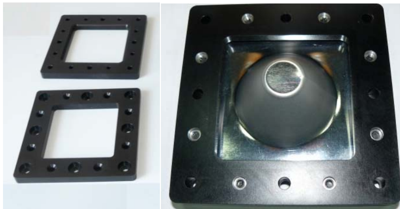
Slika 8.4 Konačna izvedba radne naprave i prstena za stezanje
